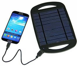
M. Chauvière, arrivé au bord de la plage, veut twitter ses exploits mais n'ayant plus de batterie il va utiliser son chargeur solaire de portable. Il est constitué de cellules photovoltaïques qui permettent de transformer l'énergie du rayonnement solaire en électricité.
